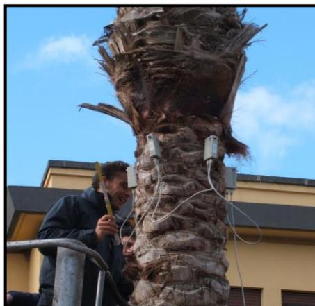
**Foto 6: Posizionamento dei sensori del tomografo**
